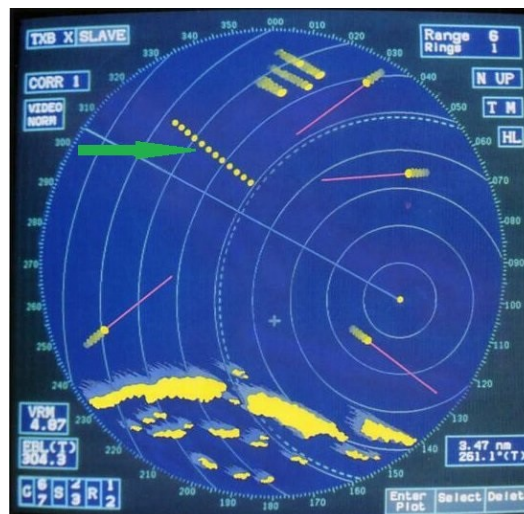
sl.12) Elektronski reflektor RACON (RADIO BeaCON)
